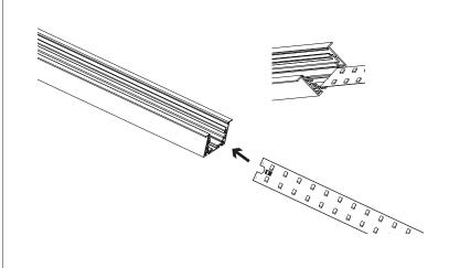
**INSTALL DIFFUSER ONTO PROFILE**
